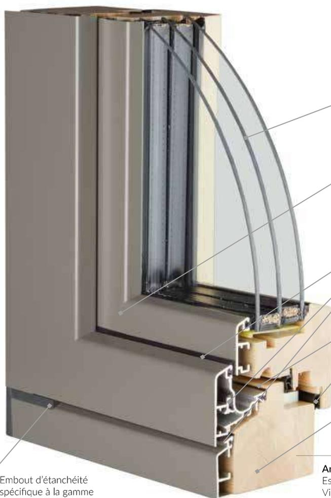
Triple Vitrage 4Fe-18-4-18-4Fe de série pour un meilleur confort thermique. Intercalaire Warm Edge noir de série. Épaisseur de vitrage de 30 à 48 mm.
