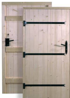
Porte de service Sapin du Nord : **panneaux frises verticales ép. 27 mm**, **dormant de 65 x 55 mm**, serrure à cylindre 1 point, **ouverture extérieure**
